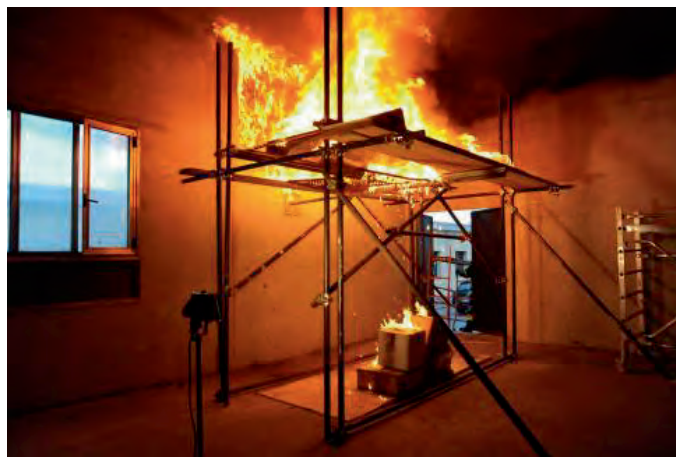
EFFETTI DEL GOCCIOLAMENTO CONSEGUENTI L'INCENDIO
