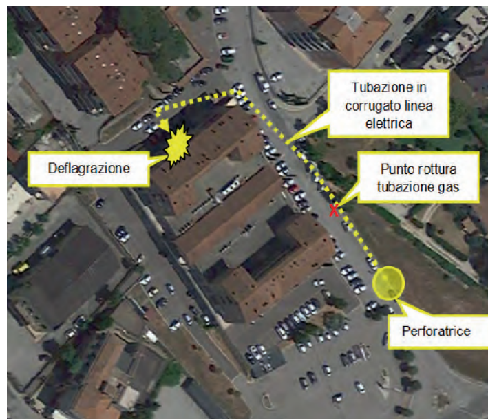
DISTANZA TRA IL PUNTO DI ORIGINE DELLA DISPERSIONE E IL PUNTO DI DEFLAGRAZIONE
