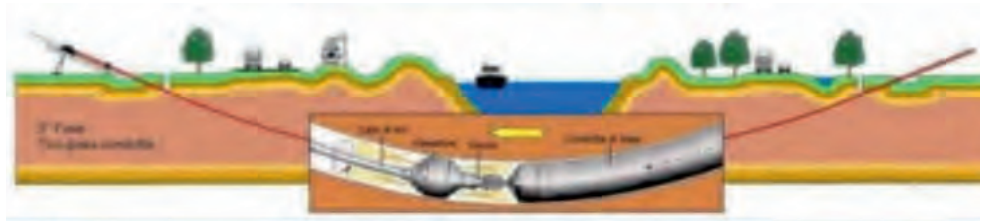
TRIVELLAZIONE ORIZZONTALE CONTROLLATA
