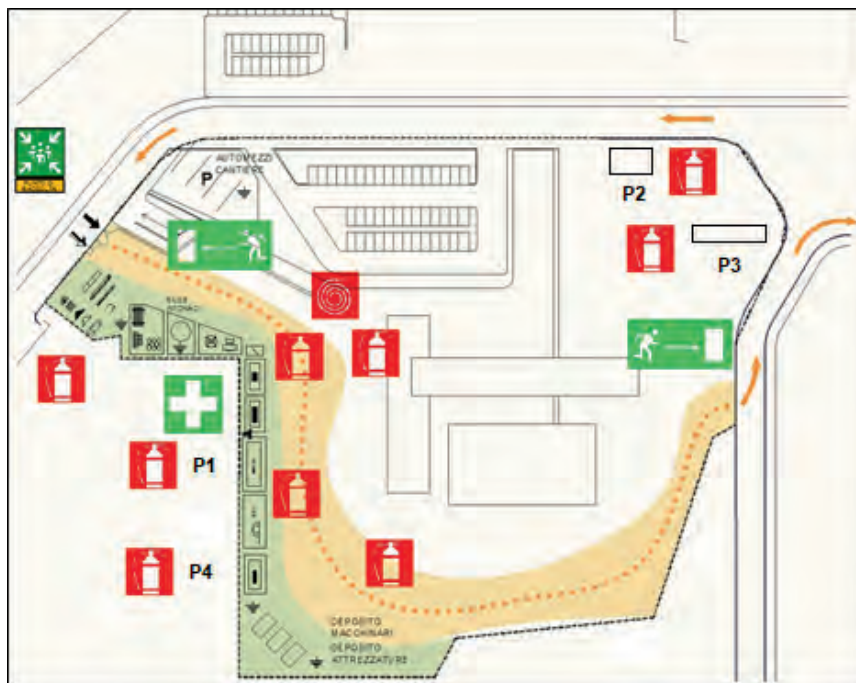
PLANIMETRIA DELL'ORGANIZZAZIONE DEL CANTIERE AI FINI ANTINCENDIO
